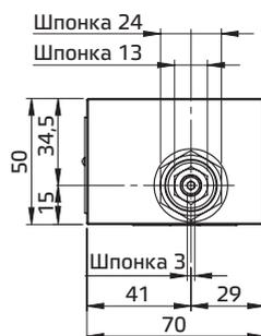
Все модульные клапаны AM5-FX-\* соответствуют стандартам ISO и СЕТОР для размеров монтажных поверхностей. Высота клапанов составляет 50 мм. Утечка между клапаном и монтажной поверхностью предотвращается посредством полного прижима к седлам 4 уплотнительных колец типа OR или уплотнений квадратного сечения типа Quad-Ring.
