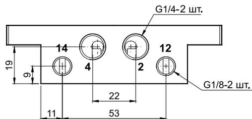
Монтажная поверхность для установки на плату в соответствии с ISO 5599-1(размер 1)
