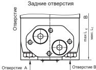
C : 4xM10-10 мм,  $P_{\text{(A,B)}}$ : 2xG3/4 or 2xM27x2-17мм T : G1/4 or M14x1,5-12 мм, глубина
