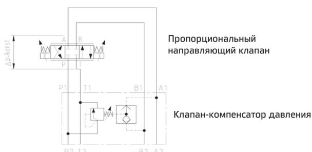
3-линейный клапан-компенсатор давления прямого действия модульной версии с монтажной поверхностью согласно стандартам CETOP и ISO. Его функция заключается в поддержании перепадов давления DP между линиями P и A или B. Как правило, используется вместе с направляющими пропорциональными клапанами для регулировки потока независимо от изменений давления. Выбор давления управления в линиях А и В осуществляется автоматически обратным клапаном, встроенным в клапан-компенсатор.
