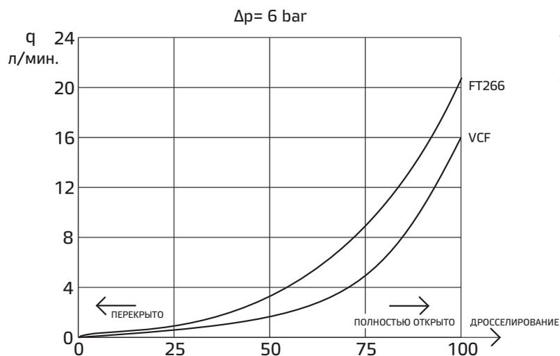
Типовые графики Q для различных секций дросселирования и фиксированный перепад давлений Δp = 6 бар для клапанов FT266/VCF Стандартная конфигурация с минеральным маслом при v = 42 cСт и 50°C.
