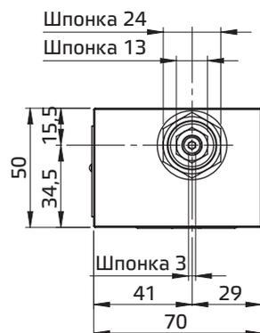
Все модульные клапаны AM5-FC-\* соответствуют стандартам ISO и СЕТОР для размеров монтажных поверхностей (см. также первую страницу). Высота клапанов составляет 50 мм. Утечка между клапаном и монтажной поверхностью предотвращается посредством полного прижима к седлам 4 уплотнительных колец типа OR или уплотнений квадратного сечения типа Quad-Ring.
