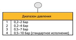
Пример заказа : регулятор — размер 3/8 (с отверстием G3/8) с диапазоном давления 0,5–7 бар: № для заказа: R14623.
